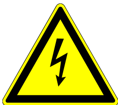
Warnung vor gefährlicher- elektrischer Spannung
