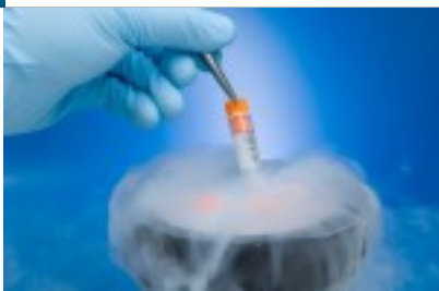
Wenn flüssiger Stickstoff verdampft, nimmt er das 700-fache Volumen ein - Erstickungsgefahr!
